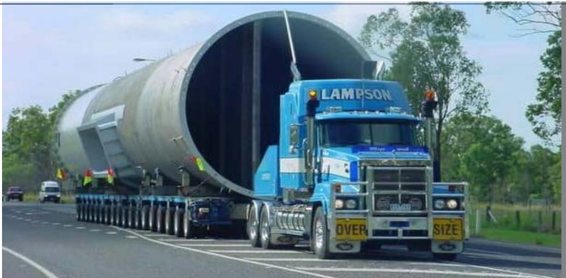
پوزی درای ۱۷ محور است و هر محور ۸ چرخ دارد که در مجموع دارای ۱۳۶ چرخ است. جدا از سختی مسیر و مشکلات متعدد، بار آن ها که ترانس برق است ممکن است با ضربه اندکی بلا استفاده شده و مرجوع شود. آن ها نمی توانند از مسیر خودروهای عادی حرکت کنند و به دلیل سنگینی بار نمی توانند از روی پل ها عبور کنند.
