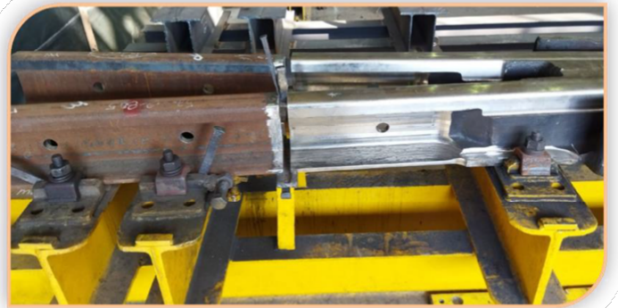
فیکسچر و پیکربندی فرایند جوشکاری تکه مرکزی از جنس فولاد هادفیلد
