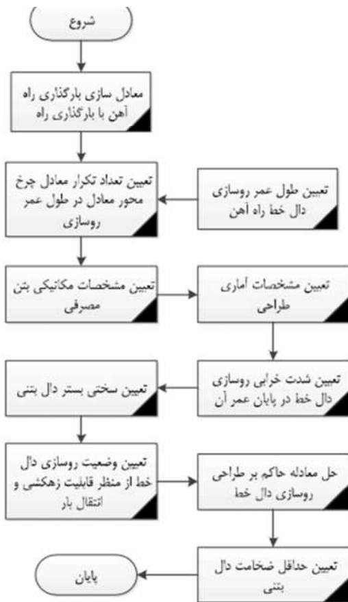
الگوریتم تعیین ضخامت دال بتنی در روسازی دال خط راه آهن به کمک روش AASHTO
