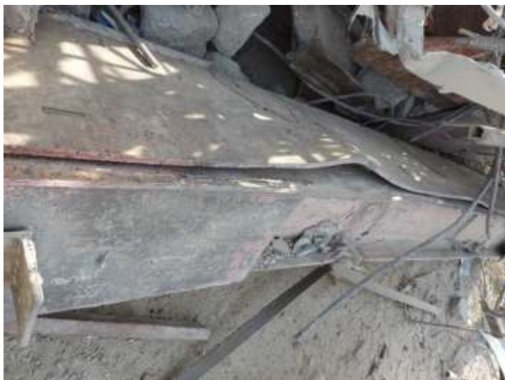
تصویر ۱-۱۷ نمایی از ستون ساخته شده در کارگاه و کیفیت جو شکاری، برداشت تیم کارشناسی اعزامی پژوهشگاه از محل دپوی مصالح ساختمان متروپل، تیر ۱۴۰۱
